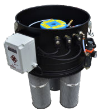
SP Pulizia cartucce in controcorrente d'aria Filtro antistatico classe M (EN 60335-2-69) 3 Cartucce poliestere antistatico 9 m² superficie filtrante
