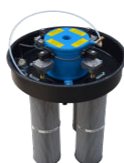
SP Pulizia cartucce in controcorrente d'aria Filtro antistatico classe M (EN 60335-2-69) 4 Filtri poliestere antistatici 12 m² superficie filtrante
